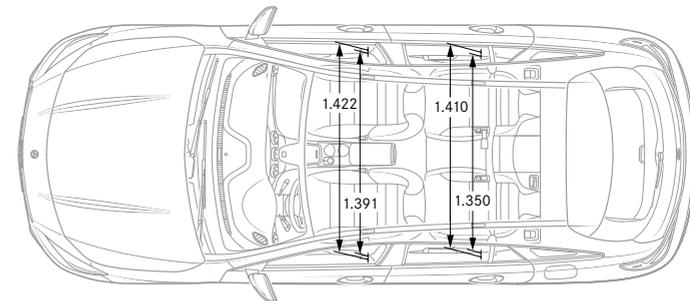
Alle Angaben in Millimetern. Die abgebildeten Maße sind Mittelwerte. Sie gelten für den CLA 180 in Grundausstattung und in unbelastetem Zustand.
